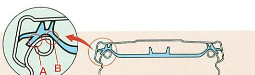
合成樹脂製品で、スカート頂部のA・B2面に接しているため、シートパッキンに比べ、スカートの打痕等による漏洩に強い構造です。また耐荷重性にも優れた製品です。
