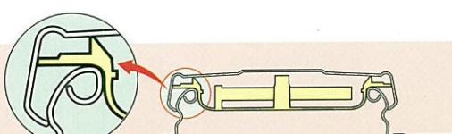
合成樹脂の内蓋、専用取手が組み込まれた製品です。開封後的小出し作業を図る目的で開発されました。パッキンは不要で、耐荷重性も極めて高い製品です。
