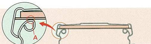
スカート頂部のAに接面し、内容液の漏洩を防ぎます。
